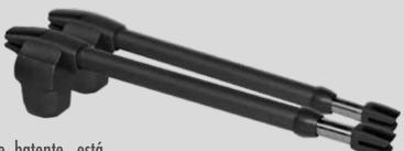
Desenvolvido para a automatização de portões de batente, está disponível em 230V. O curso de 600mm possibilita a automatização de portões até 4 metros por folha. Além disto, um motor direito pode ser facilmente transformado em esquerdo pelo instalador e vice-versa, invertendo apenas a direção de algumas peças.
