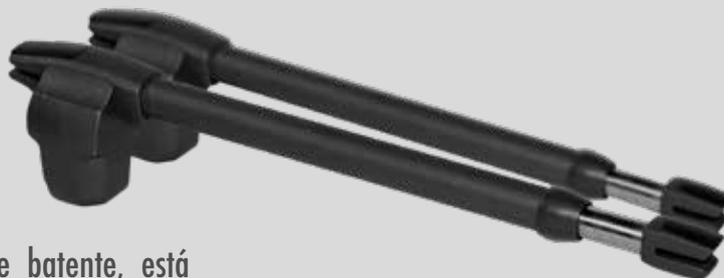
Desenvolvido para a automatização de portões de batente, está disponível em 230V. O curso de 300mm possibilita a automatização de portões até 2,5 metros por folha. Além disto, um motor direito pode ser facilmente transformado em esquerdo pelo instalador e vice-versa, invertendo apenas a direção de algumas peças.
