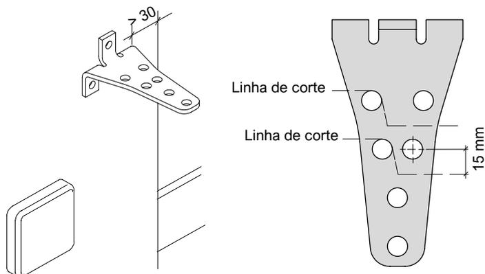
Para encurtar adequadamente o suporte, corte 15 mm a partir do centro do orifício, conforme mostrado na figura. Fixe o atuador ao suporte traseiro seguindo o procedimento:
