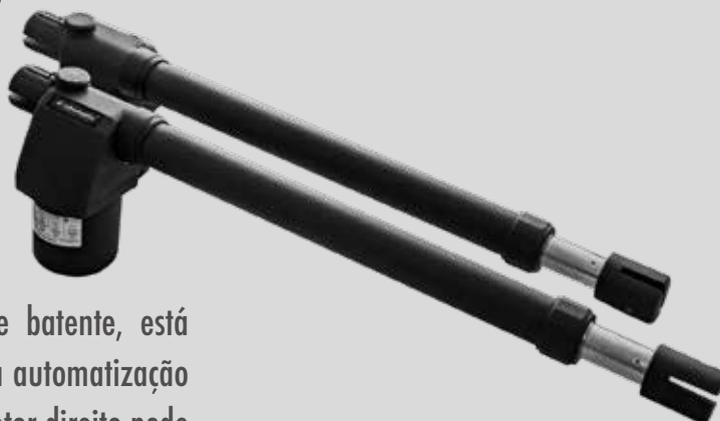
Desenvolvido para a automatização de portões de batente, está disponível em 230V. O curso de 400mm possibilita a automatização de portões até 3 metros por folha. Além disto, um motor direito pode ser facilmente transformado em esquerdo pelo instalador e vice-versa, invertendo apenas a direção de algumas peças.
