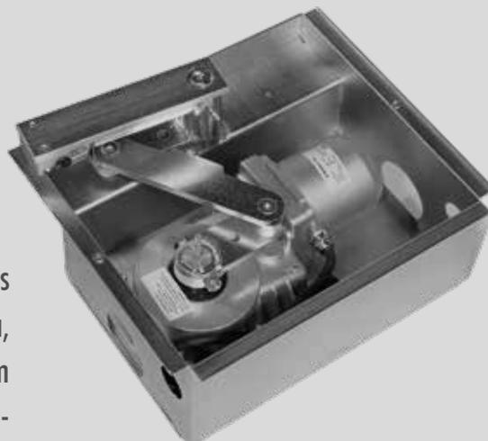
O SUBWING permite a aplicação em portões de batente com folhas até 2,5m. É discreto pois fica soterrado por baixo da base da folha, tornando-o praticamente invisível mas extremamente eficaz. Em portões chapeados ou em zonas de vento deve ser aplicada fechadura.
