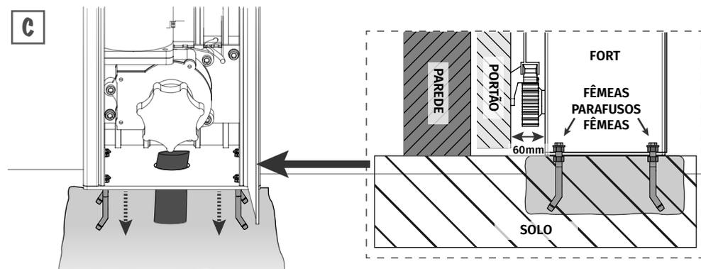
**03** • Aplique o motor com os parafusos na base de betão. Deve garantir que o motor se encontra nivelado (recorra a um nível). Alinhe o motor paralelamente ao portão, mantendo uma distância de 60mm entre eles, como visível na imagem.
