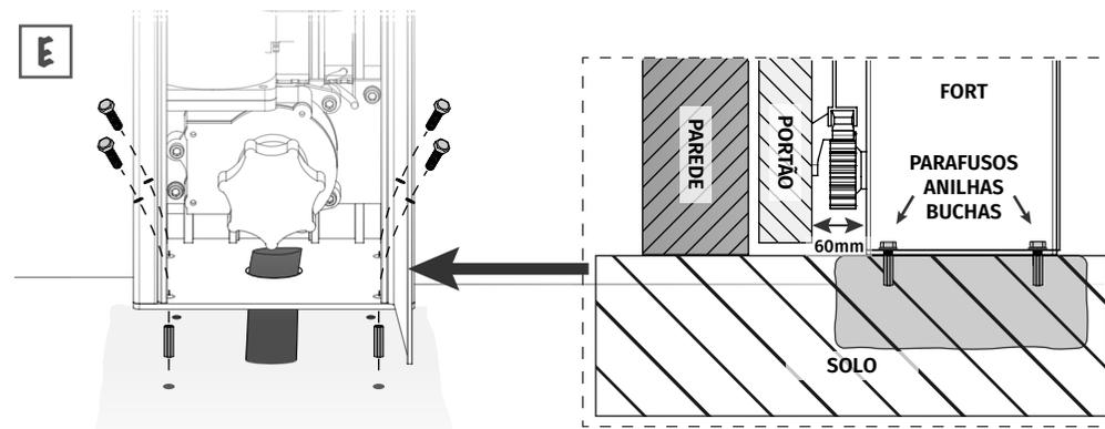
**05** • Coloque o automatismo na sapata de betão. Aperte com parafusos (garanta que o FORT se encontra nivelado).
