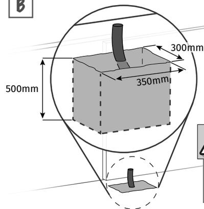
**01** • Faça um buraco no solo para criar uma sapata em betão. As dimensões apresentadas são as recomendadas na criação da sapata. Deve deixar tubos no meio, para a passagem de cabos para alimentação e acessórios.
