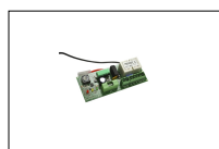
B71/BC Carregador de baterias para controladores digitais Brushless B70/1DC - B70/1T.
